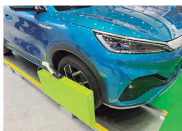
▲充電機の設置はEV車の充電口に合わせる必要がある。
